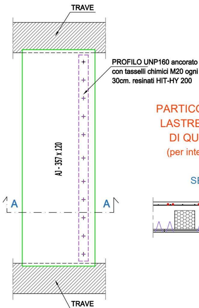
**PARTICOLARE RINFORZO LASTRE IN PROSSIMITA' DI QUELLE RIMOSSE (per interruzione armatura)**
